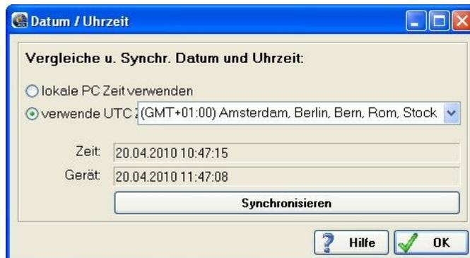
4. Über den Punkt *RTC setzen...* kann die Uhrzeit des ADL-MX neu gestellt werden. Hierbei besteht die Auswahl zwischen *lokale PC Zeit verwenden* und *verwende UTC Zeit*.
