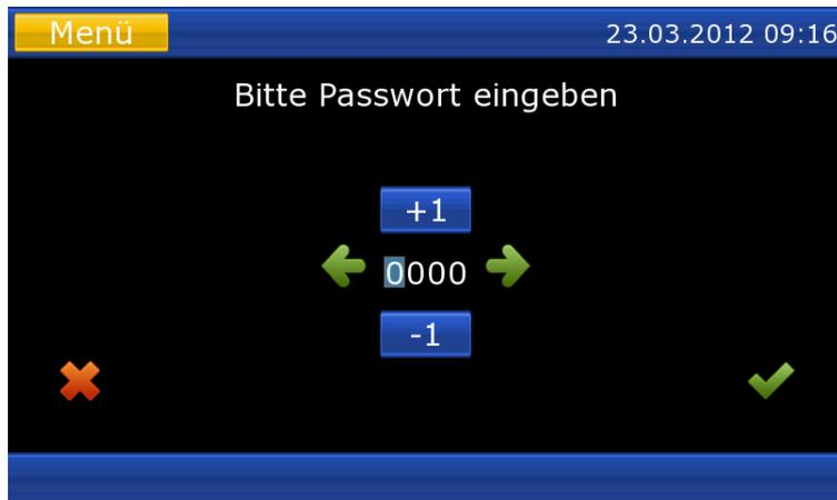
Um in das Menü „Setup“ zu gelangen muss ein Passwort eingegeben werden. Das Default- Passwort lautet „0000“ weiterhin kann das Passwort über die Weboberfläche geändert werden.
